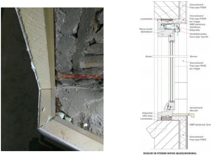
Figuur 9: voorbeeld binnengevelisolatie
